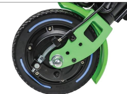
Double système de freinage (freins à tambour et freins électroniques).
