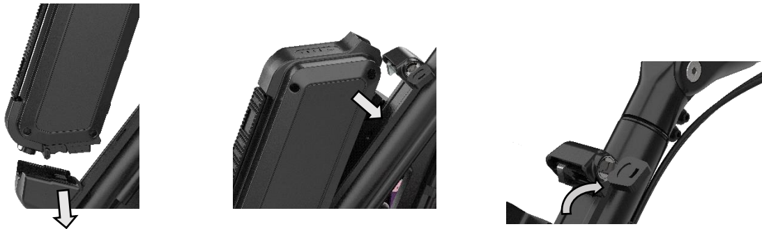
Figure 43. Placez la batterie dans son support.
