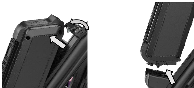
Figure 44. Retrait et remplacement de la batterie.
