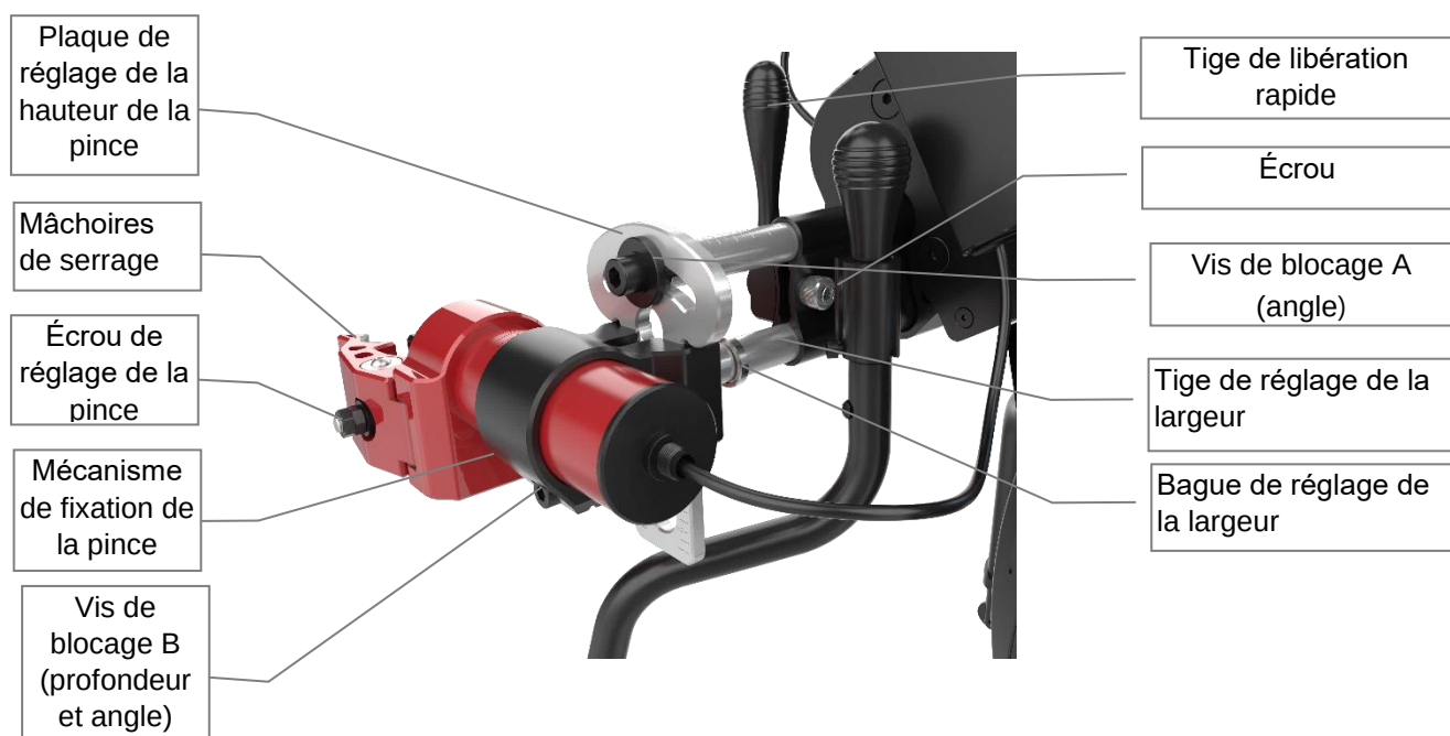
Figure 13. Ensembles de montage pour la pince automatique et le système de réglage de la largeur
