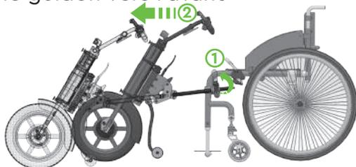
Connecter et déconnecter la roue doit être sans difficulté. Si connecter ou déconnecter demande un gros effort, c'est que l'installation n'est pas faite correctement ou qu'une pièce est cassée. Contrôler l'installation et contacter votre prestataire.
