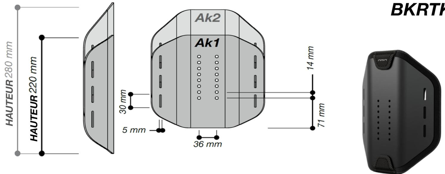
La plaque en aluminium est livrée avec un coussin de 30mm d'épaisseur haute-densité et d'une housse ignifugée et respirante.
