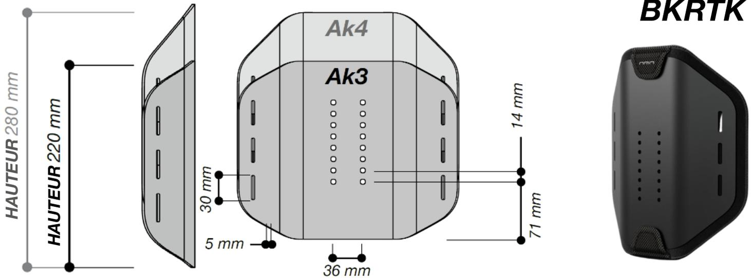
La plaque en aluminium est livrée avec un coussin de 30mm d'épaisseur haute-densité et d'une housse ignifugée et respirante.
