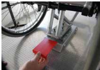
Image 13 Déverrouillage manuel de la station d'ancrage Dahl
