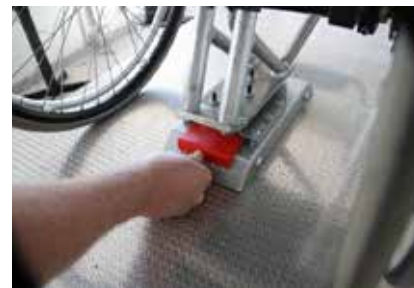
Image 14 Insertion de l'outil de déverrouillage
