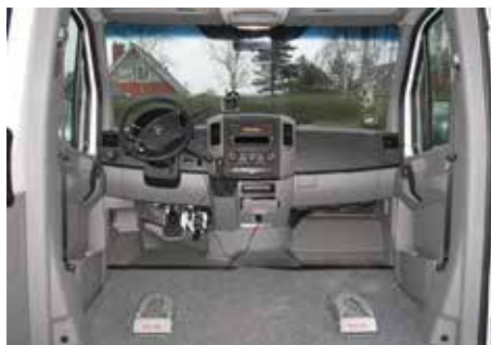
Image 11 Système d'ancrage Dahl dans un véhicule
