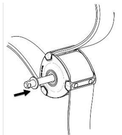
ÉTAPE 10. Maintenez en place les écarteurs en acier en faisant glisser la rondelle en caoutchouc sur l'axe de la roue Loopwheels™.
