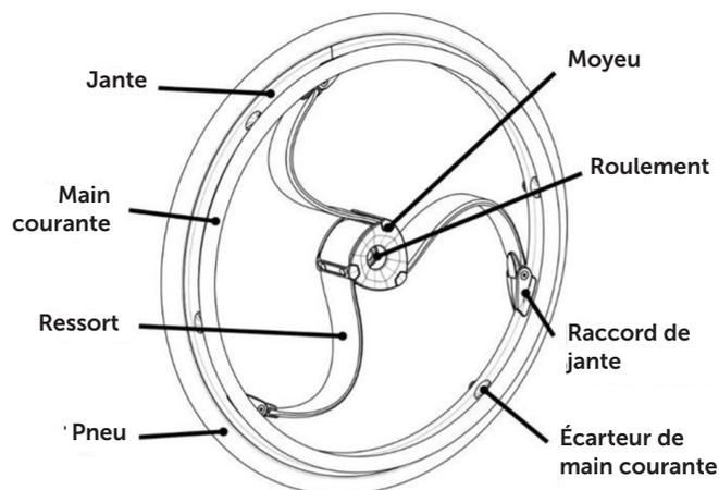
Votre roue peut différer légèrement du schéma, car chaque roue Loopwheels est fabriquée individuellement selon les spécifications de la commande.
